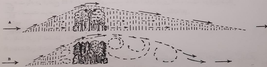
شکل ۷-۱۳ نیز وضع جریان باد از روی یک بادشکن با نفوذپذیری متوسط (A) و یک بادشکن متراکم (B) را نشان می دهد.
